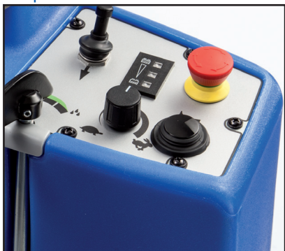
Панель управления с кнопкой аварийной остановки
